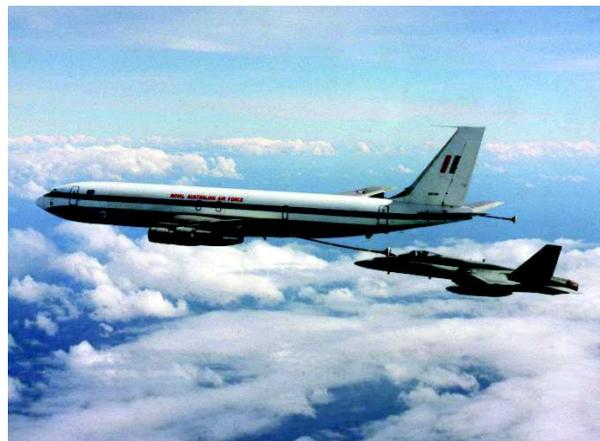
*Boeing-707 utilisé en ravitaillement (KC 135) ⚡*
