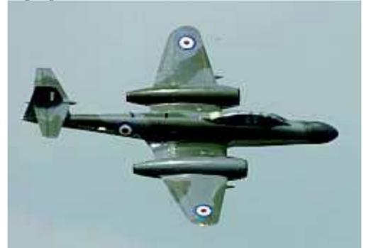
Le 7 novembre 1945, un **Gloster-Météor** (canons démontés et des moteurs modifiés !) obtint le **record du monde de vitesse** : 976 km/h. L'année suivante, un Meteor F.4 (avec des ailes tronquées de 1,47 mètre) portera le record à 991 km/h.
