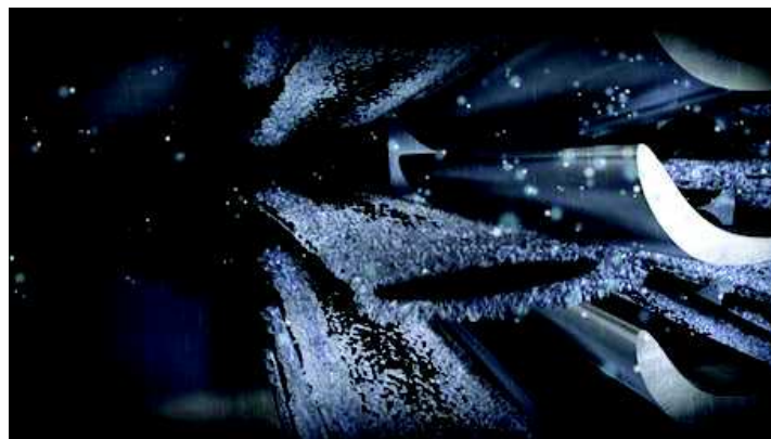
Givre dans un compresseur.
