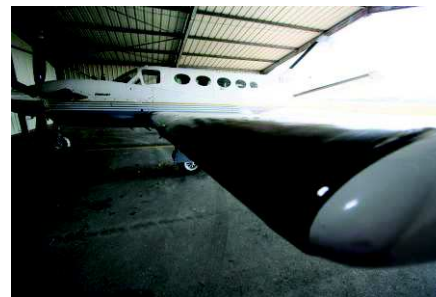
Boudins gonflables de bord d'attaque d'aile.
