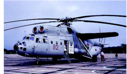
Mil Mi 6 Hook (rotor 5 pales diamètre 35 m)
