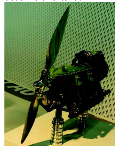
Moteur Renault à refroidissement par eau (1915) 220 cv et 12 cylindres en V à 50°. Type 12 F
