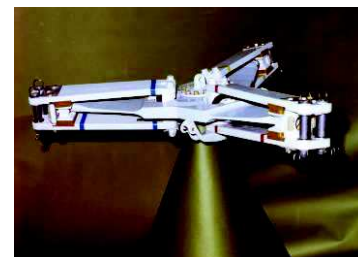
Tête de rotor "Starflex" (partie bleue clair sur l'image ci-contre) en composite (écureuils). Avec plateaux cycliques et vérins de commande.
