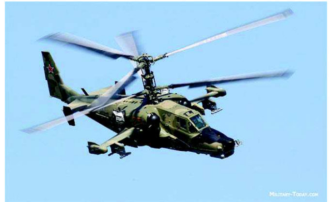
Les rotors contrarotatifs coaxiaux chez Kamov
