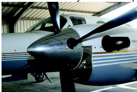
Dispositifs thermiques en pied de pale d'hélice.
