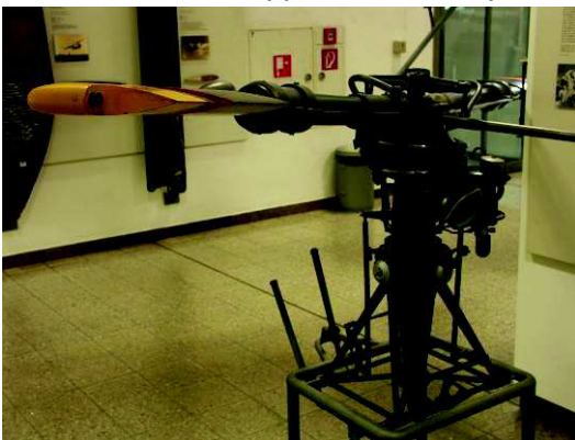
Sortie d'air sur l'extrémité de la pale du Djinn
