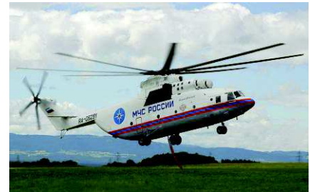
MIL MI 26T (rotor 8 pales diamètre 32 m Charge utile 40 tonnes)
