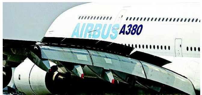
A 380 en finale (spoilers et volets)
