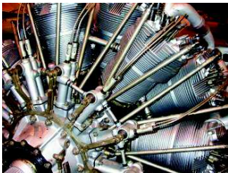
Ailettes de refroidissement d'un Clerget diesel en étoile avec double rangée de cylindres
