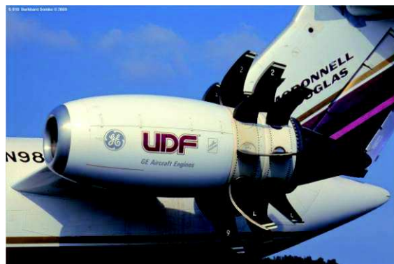
Le moteur propfan Open rotor en test sur un MD-81 Demonstrator
