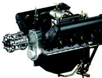
en V (8 cyl en V - Hispano Suiza du Spad VII)
