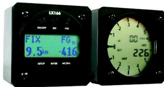
Le modèle LX 166 capable aussi d'afficher le plan de descente vers l'aérodrome de départ !
