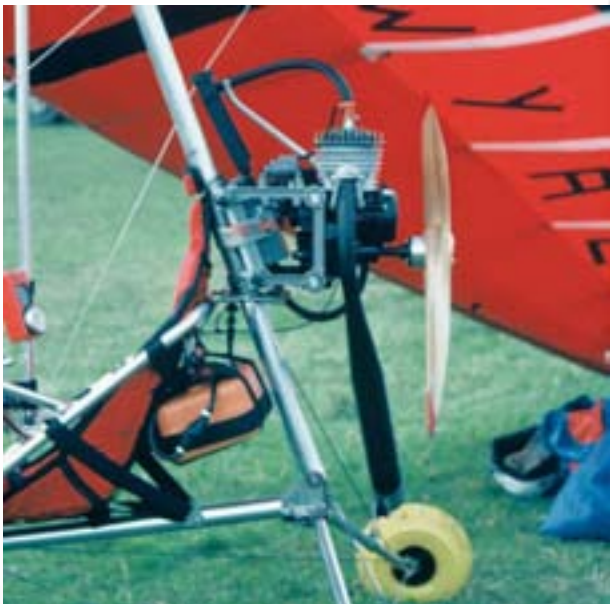
Le chariot KDA d'Alain Dreyer immatriculé FW, moteur Hiro refroidi par eau à réducteur mécanique et démarrage électrique (le grand luxe !)
