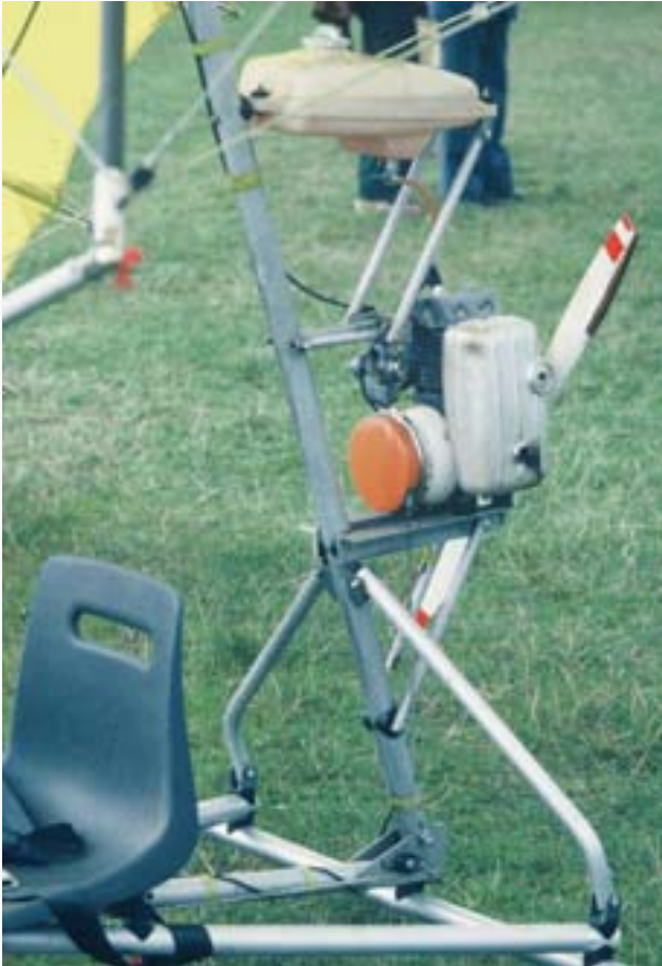
Le moteur Solo du Mosquito a un réducteur mais pas encore le pot raccordé
