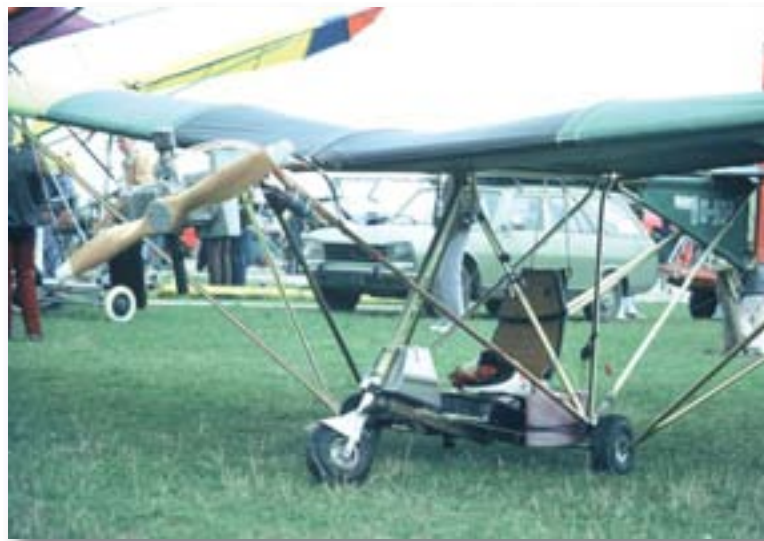
Le moteur Solo du Mosquito a un réducteur mais pas encore le pot raccordé
